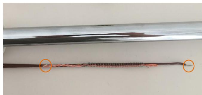
Slika 21. Grijač s dva termopara
