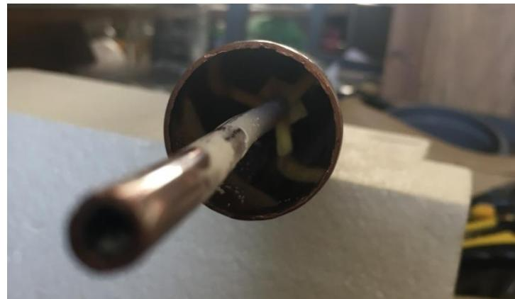
**Slika 17.** Izvedba elektrofiltera cijev u cijevi
