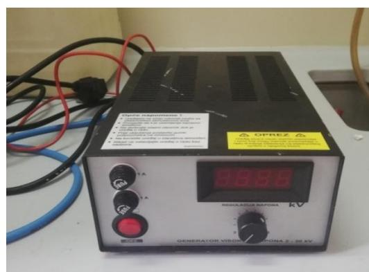
**Slika 20.** Generator visokog napona, 2 kV-30 kV
