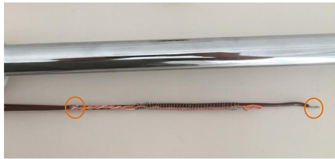
Slika 21. Grijač s dva termopara
