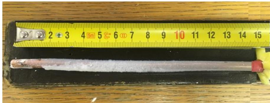
**Slika 36.** Prikupljanje čestica *Aerosila* pri  $U = 10 \text{ kV}$ ,  $\dot{m} = 0,385 \text{ g/s}$
