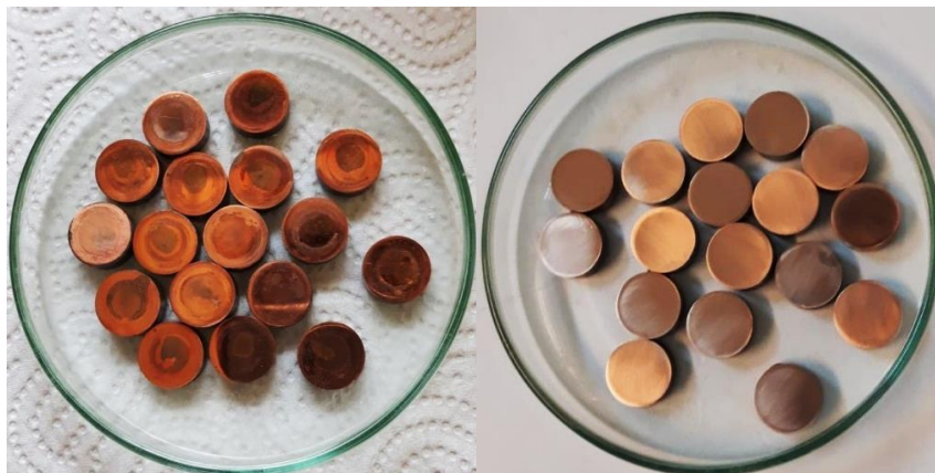
Slika 8. Prikaz bakrenih elektroda prije i poslije poliranja
