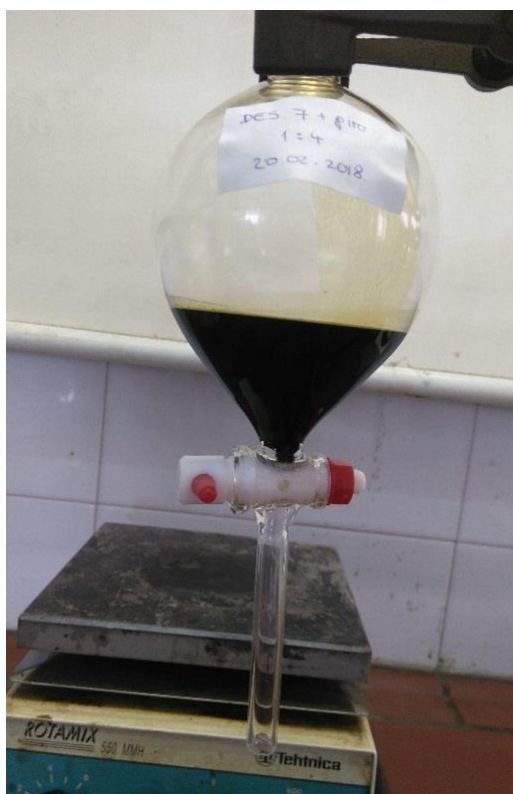
Slika 14. Ekstrakcija u lijevku za odjeljivanje
