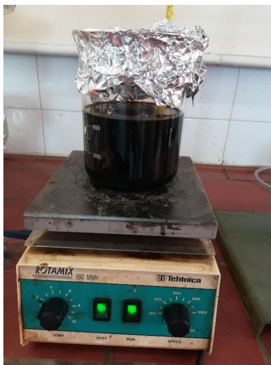
Slika 13. Grijanje smjese DES-a i pirolitičkog ulja na mješalici
