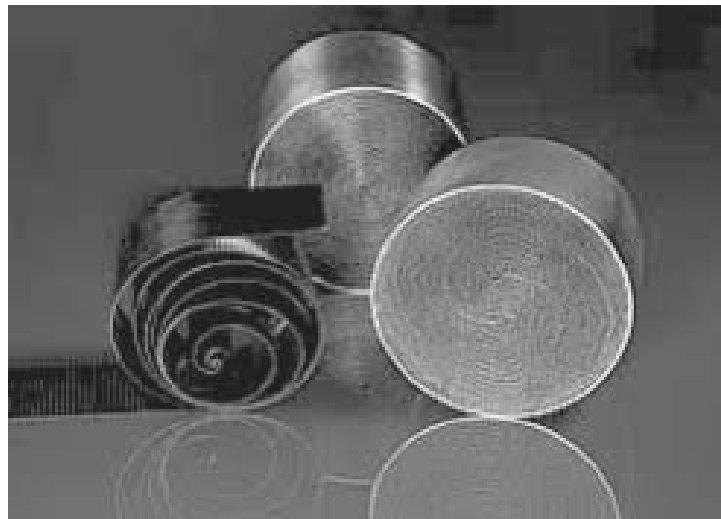
Slika 12- Priprava metalnih monolita [28]
