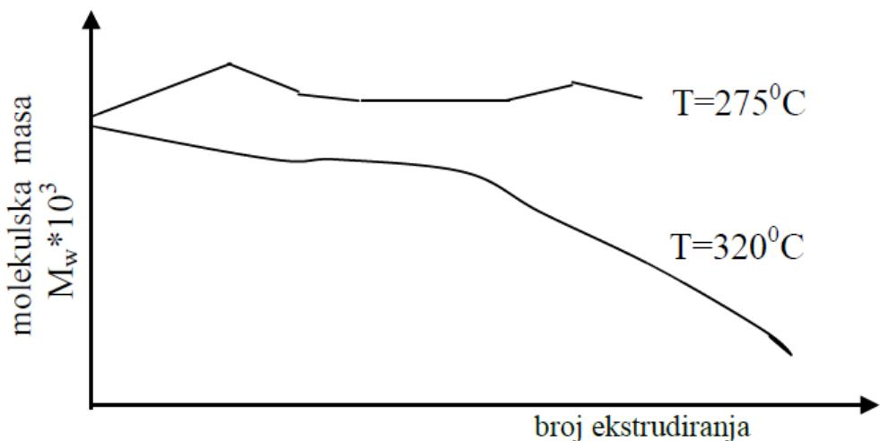
**Slika 7.** Utjecaj višekratnog ekstrudiranja na promjenu molekulske mase uzorka polikarbonata pri različitim temperaturama<sup>6</sup>
