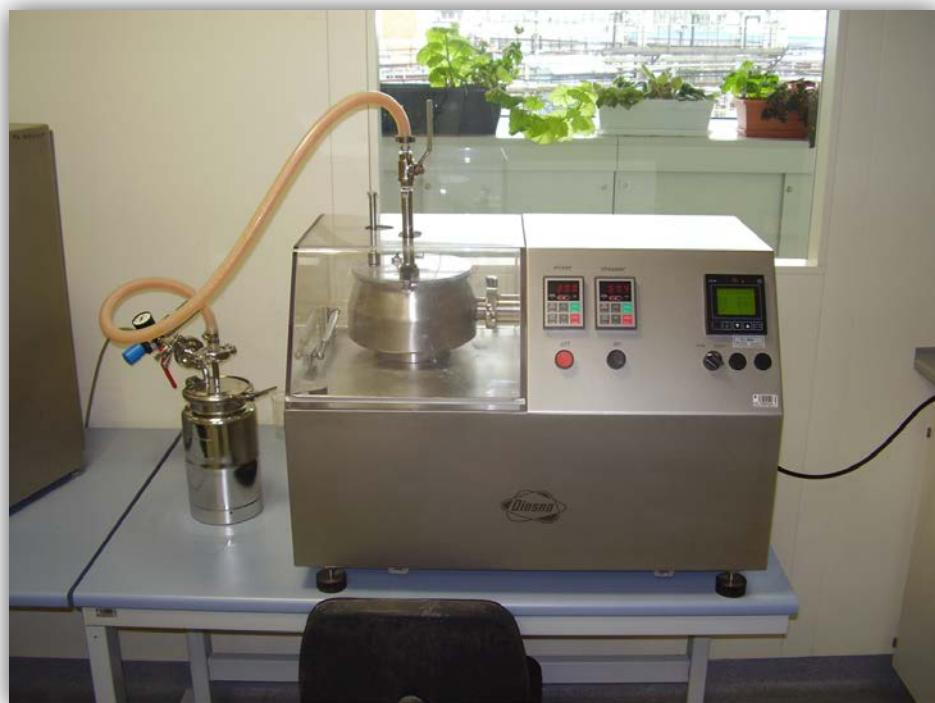
**Slika 2.5.** Fotografija smičnog granulatora
