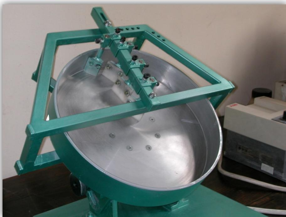
**Slika 2.6.** Fotografija disk granulatora u laboratorijskom mjerilu
