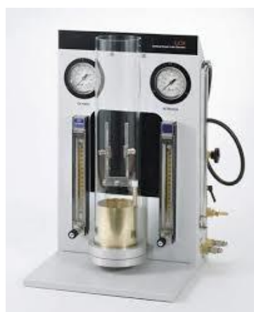
Slika 10. Uređaj za određivanje minimalne koncentracije kisika
