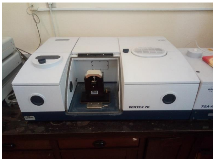
Slika 17. Spektrofotometar Bruker VERTEX 70
