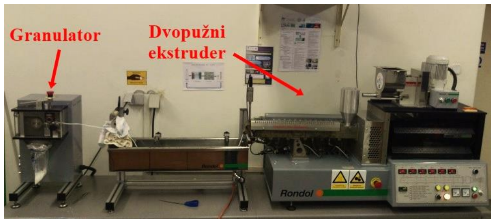
Slika 22. Dvopužni ekstruder Rondol i granulator
