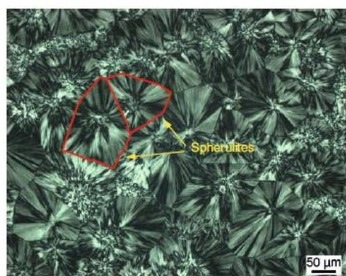
Slika 13. Sferulitne kristalične strukture u polipropilenu
