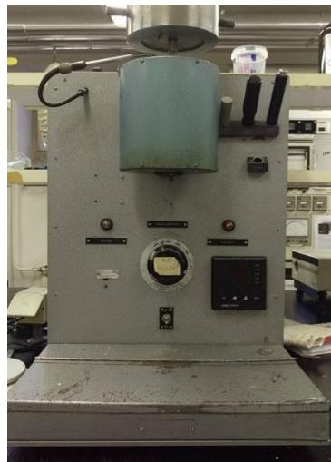
Slika 23. Uređaj za mjerjenje brzine masenog protoka taljevine (MFR)
