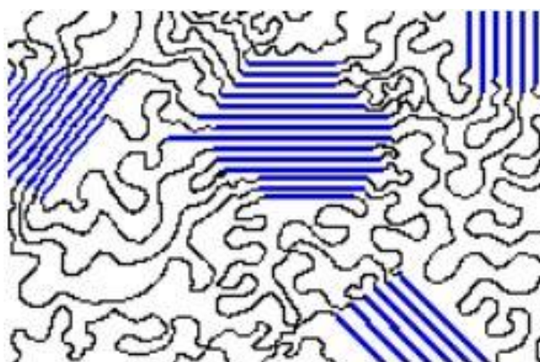
Slika 8. Raspored makromolekula u polietilenu 4
