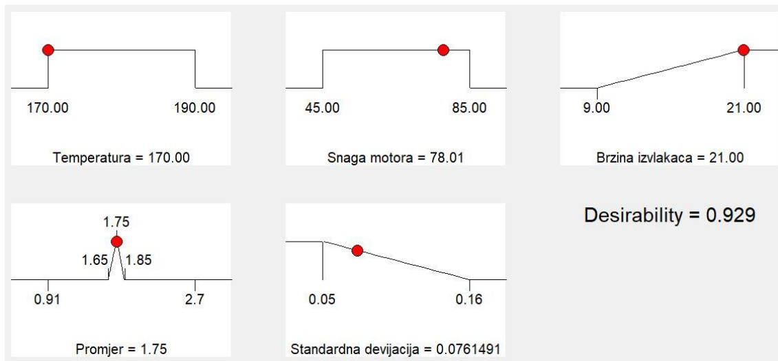
Slika 19. Grafički rezultati optimiranja za pripremu filamenata PE-HD uz zadane kriterije
