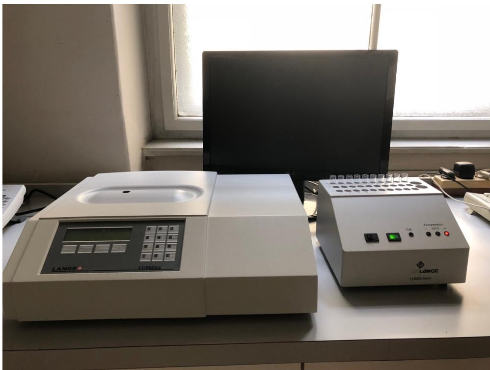
**Slika 4.** Instrument za provedbu toksičnosti LUMISTox 300 s termostatskim blokom
