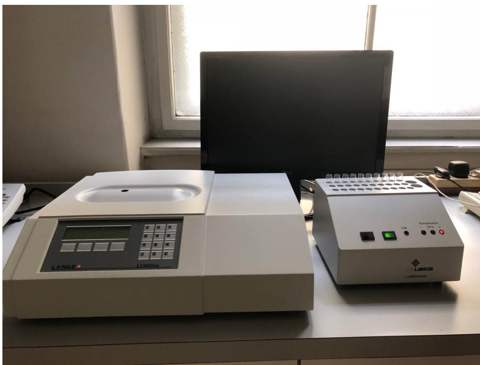
Slika 4. Instrument za provedbu toksičnosti LUMIStox 300 s termostatskim blokom LUMIStherm
