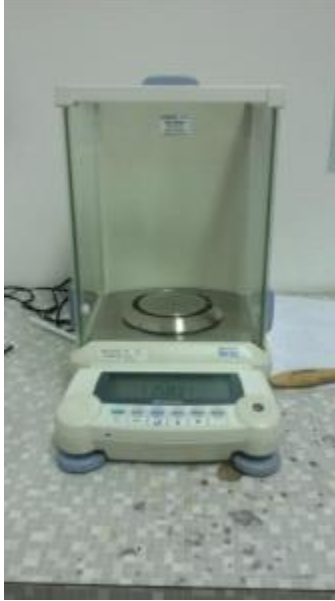
Slika 3.1. Analitička vaga AUW120 (Shimadzu, Japan)
