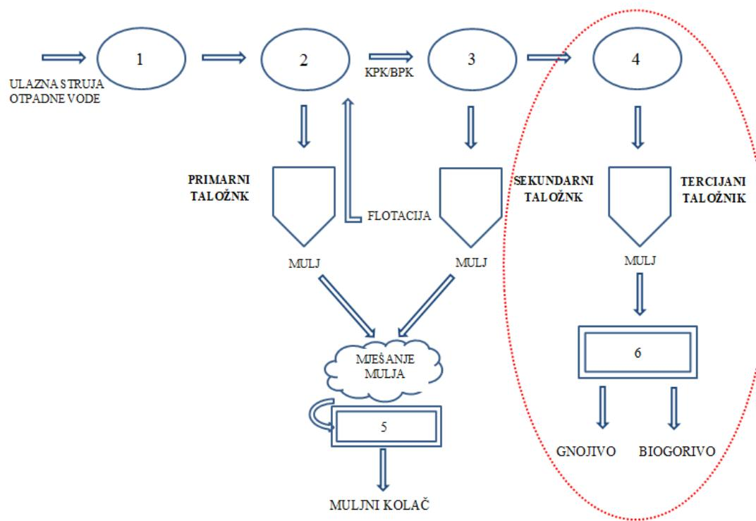
Slika 2.9. Shematski prikaz uklanjanja fosfata pri obradi otpadne vode: 1-prethodni stupanj obrade, 2-primarni stupanj obrade, 3-sekundarni stupanj obrade (BPR), 4-tercijarni/napredni stupanj obrade (EBPR), 5-odvlaživanje, 6-odvlaživanje i obrada.
