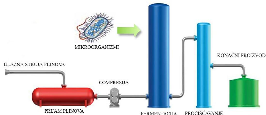
Slika 2.4. Shematski prikaz biološke obrade otpadnih plinova.
