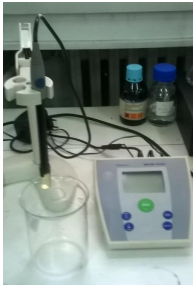
Slika 3.2.4. pH-metar Mettler Toledo S20 SevenEasy
