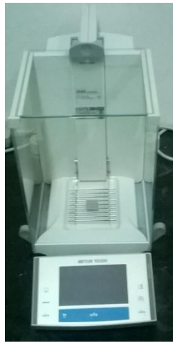
Slika 3.2.2. Analitička vaga Mettler Toledo XA105 Dual Range
