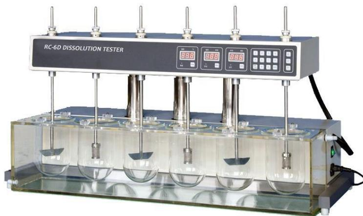
**Slika 13.** Uređaj za ispitivanje oslobađanja djelatnih tvari (RC-6D, *Zhengzhou Nanbei Instrument*)
