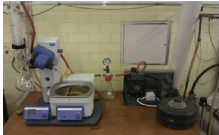
**Slika 10.** Rotacijski vakuumski isparivač (*IKA RV 10, Basic*)
