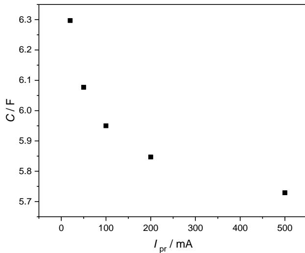
Slika 4.30. Promjena kapaciteta komercijalnog superkondenzatora sa strujom pražnjenja.
