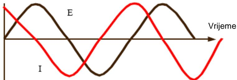
Slika 2.7. AC val za narinuti potencijal,  $E$ , i rezultirajuću struju,  $I$  [7].
