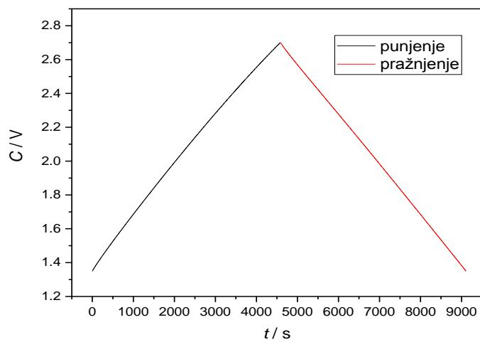
Slika 4.22. Punjenje do 2.7 V i praznjenje komercijalnog superkondenzatora do 1.35 V strujom od 2 mA
