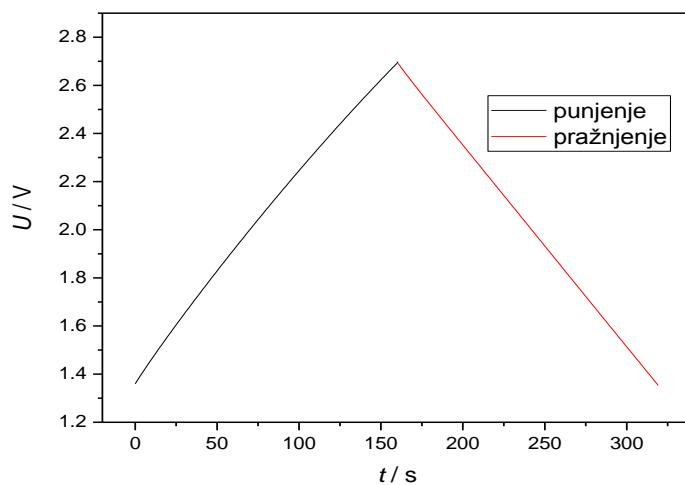
Slika 4.26. Punjenje do 2.7 V i praznjenje komercijalnog superkondenzatora do 1.35 V strujom od 50 mA
