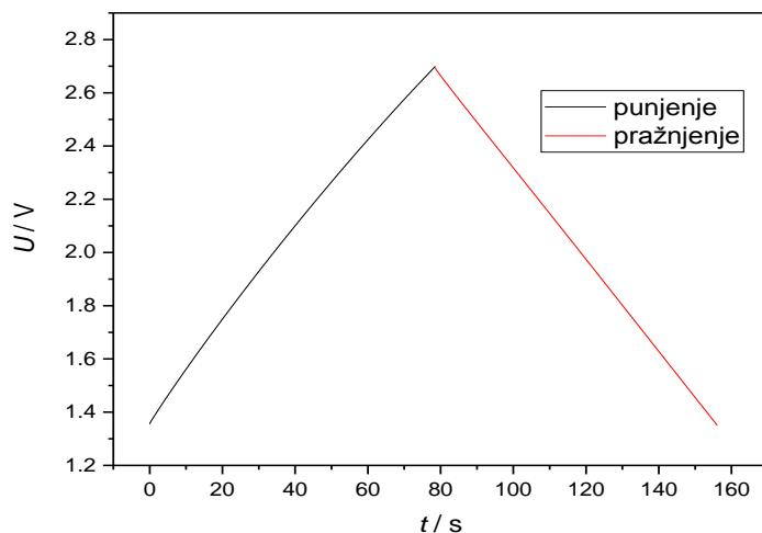
Slika 4.27. Punjenje do 2.7 V i praznjenje komercijalnog superkondenzatora do 1.35 V strujom od 100 mA
