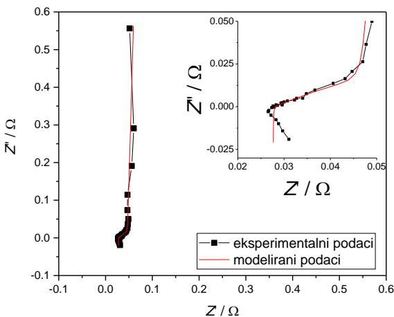
Slika 5.7. Nyquistovi dijagrami komercijalnog superkondenzatora dobiveni eksperimentalno i modeliranjem. Spektar je snimljen na dc-potencijalu 2,7 V u području frekvencija od 200 kHz do 50 mHz.
