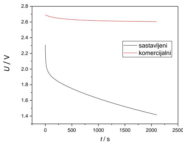
Slika 5.3b. Utjecaj struje punjenja na redistribuciju naboja sastavljenog i komercijalnog superkondenzatora na struci od 20 mA unutar 2400 s.
