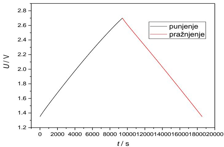
Slika 4.21. Punjenje do 2.7 V i praznenje komercijalnog superkondenzatora do 1.35 V strujom od 1 mA
