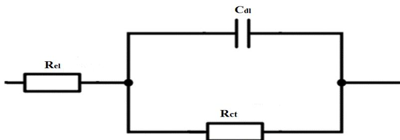
Slika 5.1. Jednostavan Randlesov električni krug [15].
