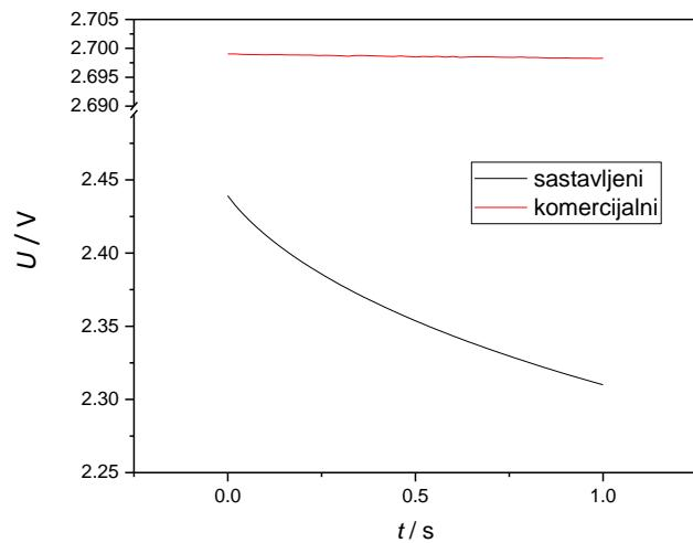
Slika 5.3a. Utjecaj struje punjenja na redistribuciju naboja sastavljenog i komercijalnog superkondenzatora na struci od 20 mA unutar 1 s.
