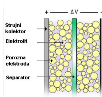
Slika 2.2. Pojednostavljena shema superkondenzatora [17].
