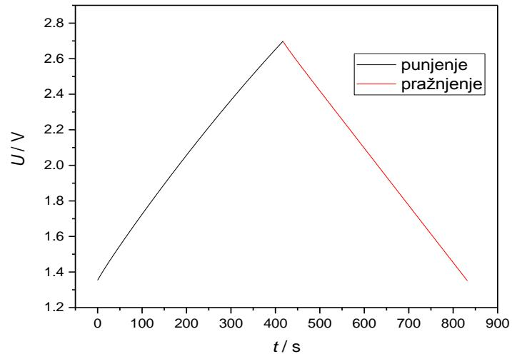
Slika 4.25. Punjenje do 2.7 V i praznjenje komercijalnog superkondenzatora do 1.35 V strujom od 20 mA
