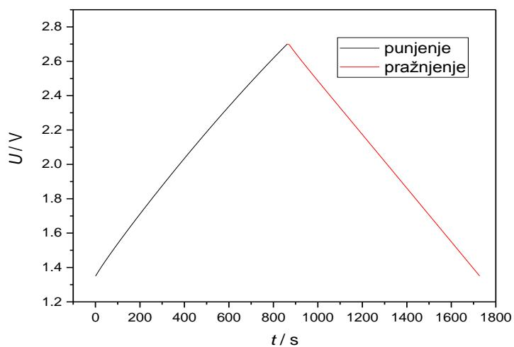
Slika 4.24. Punjenje do 2.7 V i praznjenje komercijalnog superkondenzatora do 1.35 V strujom od 10 mA
