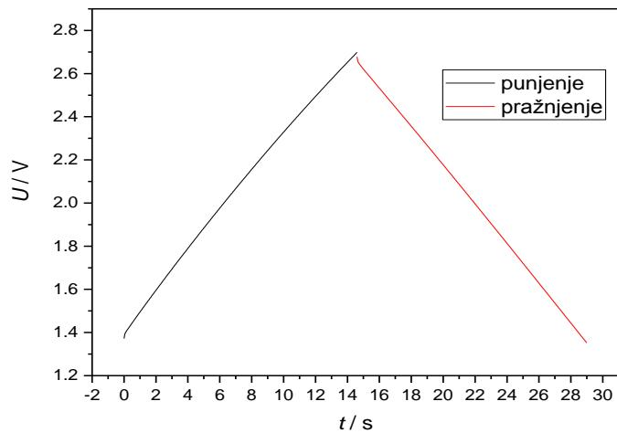
Slika 4.29. Punjenje do 2.7 V i praznjenje komercijalnog superkondenzatora do 1.35 V strujom od 500 mA
