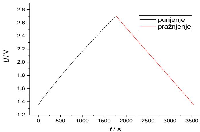
Slika 4.23. Punjenje do 2.7 V i praznjenje komercijalnog superkondenzatora do 1.35 V strujom od 5 mA
