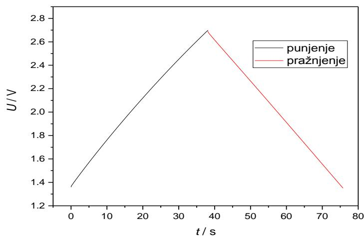
Slika 4.28. Punjenje do 2.7 V i praznjenje komercijalnog superkondenzatora do 1.35 V strujom od 200 mA
