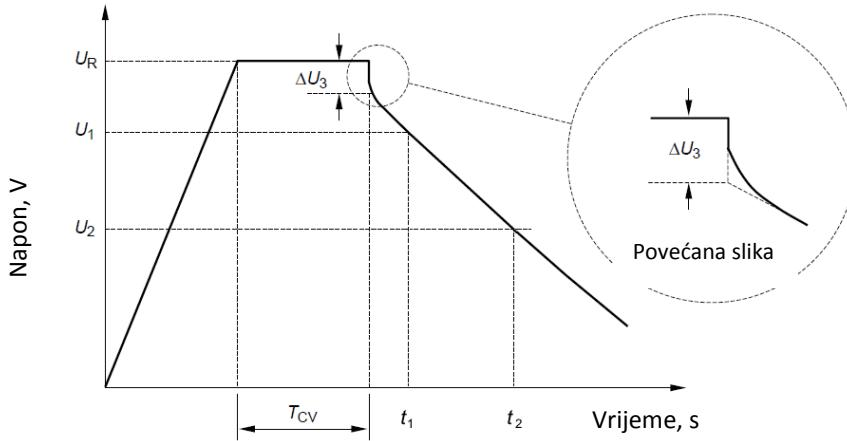
Slika 3.4. Mjerenje kapaciteta i unutarnjeg otpora [7].
