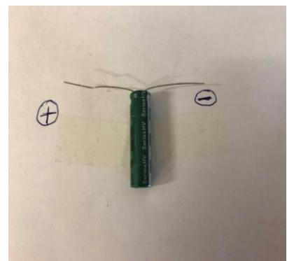
Slika 3.3. Komercijalni superkondenazator
