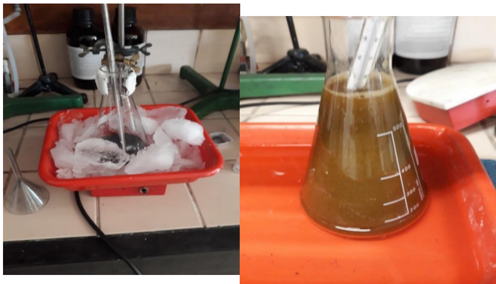
a) b) Slika 3.1. : a) Postupak pripreme grafitovog oksida Hummersovom metodom b) Produkt dobiven na kraju procesa
