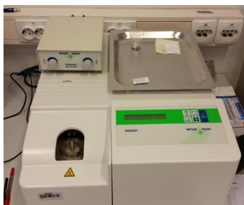
*Slika 17.* DSC uređaj MettlerToledo DSC 822<sup>e</sup>
