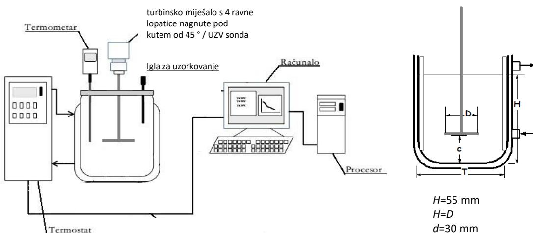
**Slika 13.** Aparatura za provođenje šaržne kristalizacije.
