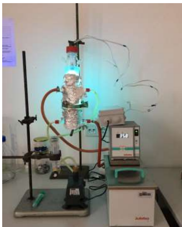
Slika 3.1. Izvedba fotoreaktora anularnog tipa sa recirkulacijom reakcijske smjese
