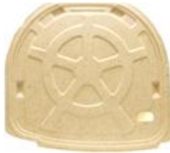
Slika 28. Rezervni pokrov guma izrađen od PLA i kenafa [22]
