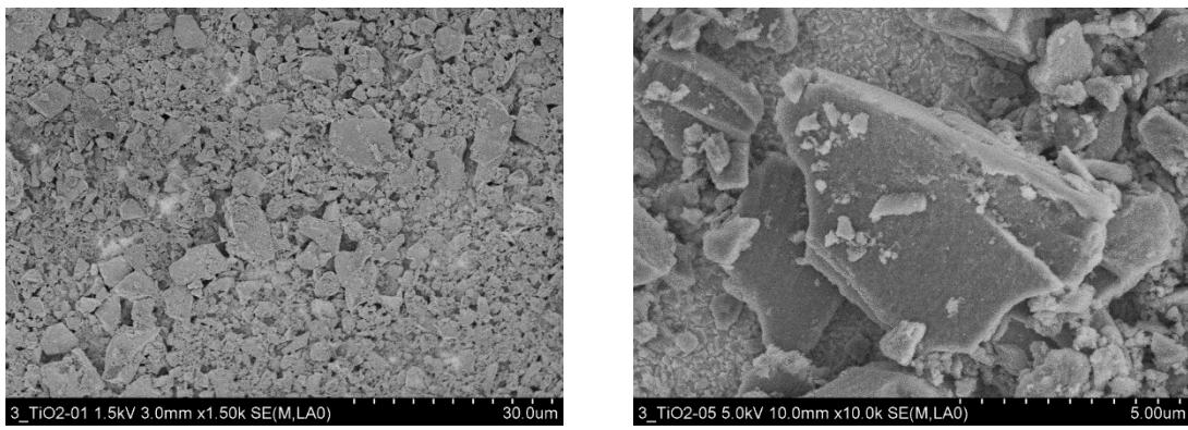
Slika 13. SEM slike prevlake C TiO<sub>2</sub> + 1 at.% Sm modificiran sa 5-ASA
