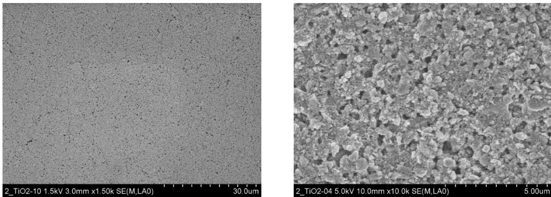
Slika 12. SEM slike prevlake B TiO<sub>2</sub> + 1 at.% Sm modificiran sa SA
