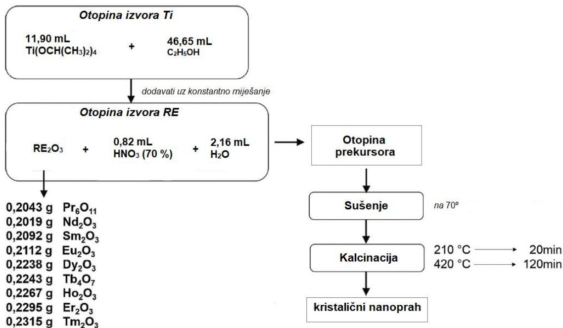
Shema 1. Postupak sinteze nanopraha  $\text{TiO}_2$  dopiranog rijetkim zemljama [1]
