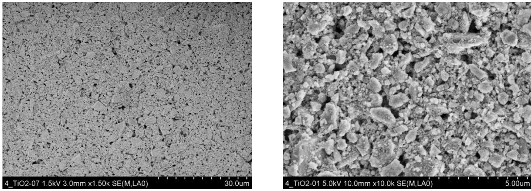
Slika 14. SEM slike prevlake D TiO<sub>2</sub> + 1 at.% Sm modificiran sa CAT
