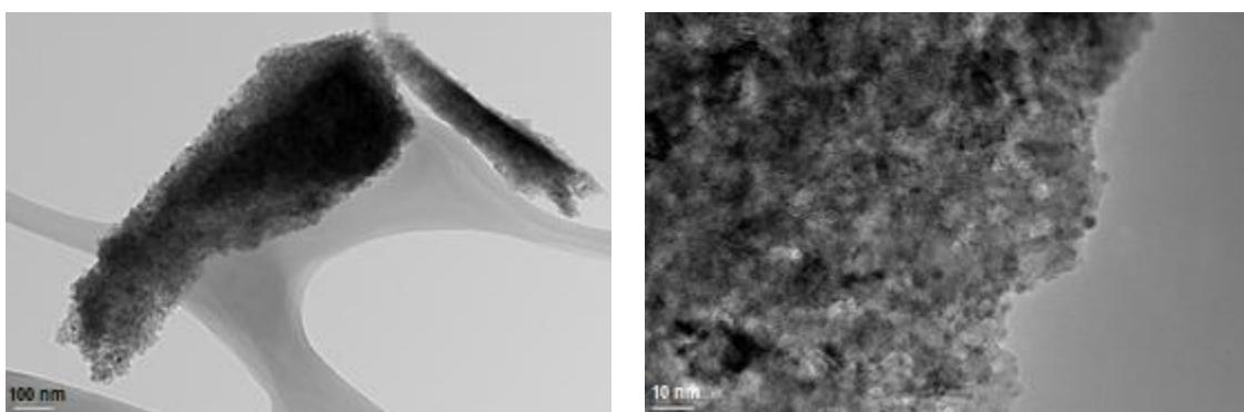
Slika 8. HRTEM slike praha D  $\text{TiO}_2 + 1 \text{ at.\% Sm}$  modificiran sa CAT
