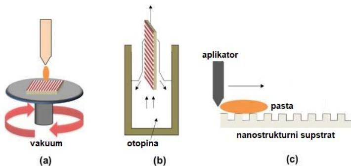
Slika 3. Tehnike razvlačenja: prekrivanje a) rotiranjem, b) umakanjem i c) raketno nožem [10]
