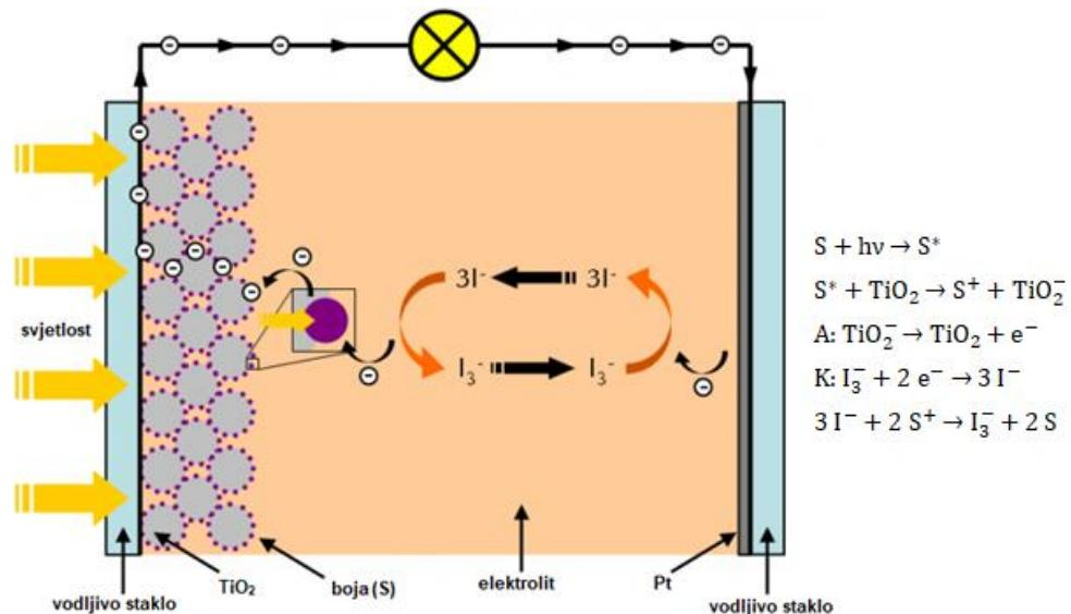
Slika 2. Princip rada DSSC i pripadajuće jednadžbe [7]
