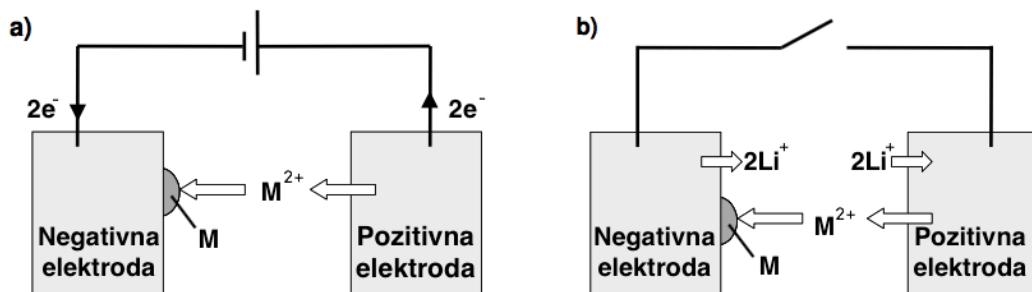
**Slika 2.6** Mogući mehanizmi otapanja prijelaznih metala koji prenose samo naboje u članku tijekom cikliranja (a) ili u uvjetima otvorenog strujnog kruga (b) [1]
