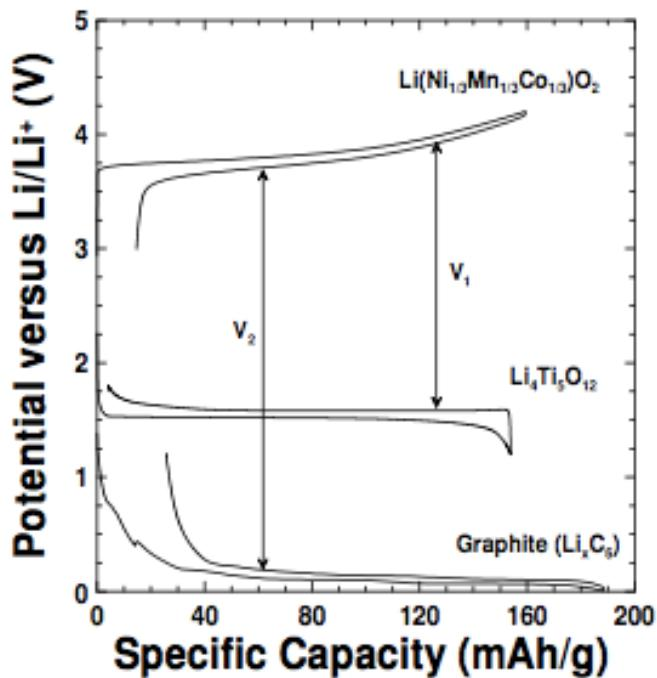
Slika 2.2 Grafički prikaz ovisnosti potencijala o specifičnom kapacitetu [1]
