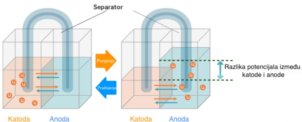
**Slika 2.1** Mechanizam rada Li ion baterije- punjenjem elektroni putuju s katode prema anodi, a  $\text{Li}^+$  s katode prema anodi. Kod pražnjenja se odvija suprotan proces [13]
