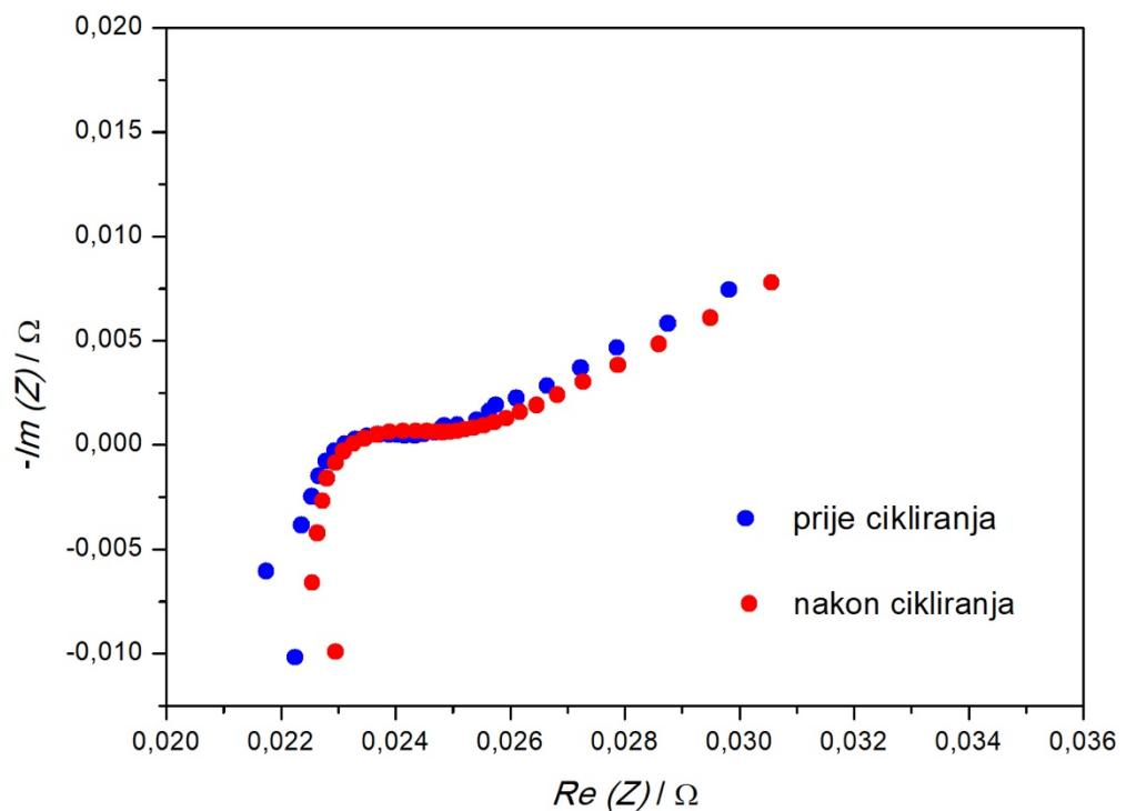
**Slika 4.6** Nyquistov prikaz ovisnosti imaginarnе komponente o realnoj komponenti impedancije za ispraznjeni članak (3,0V) prije i nakon cikliranja
