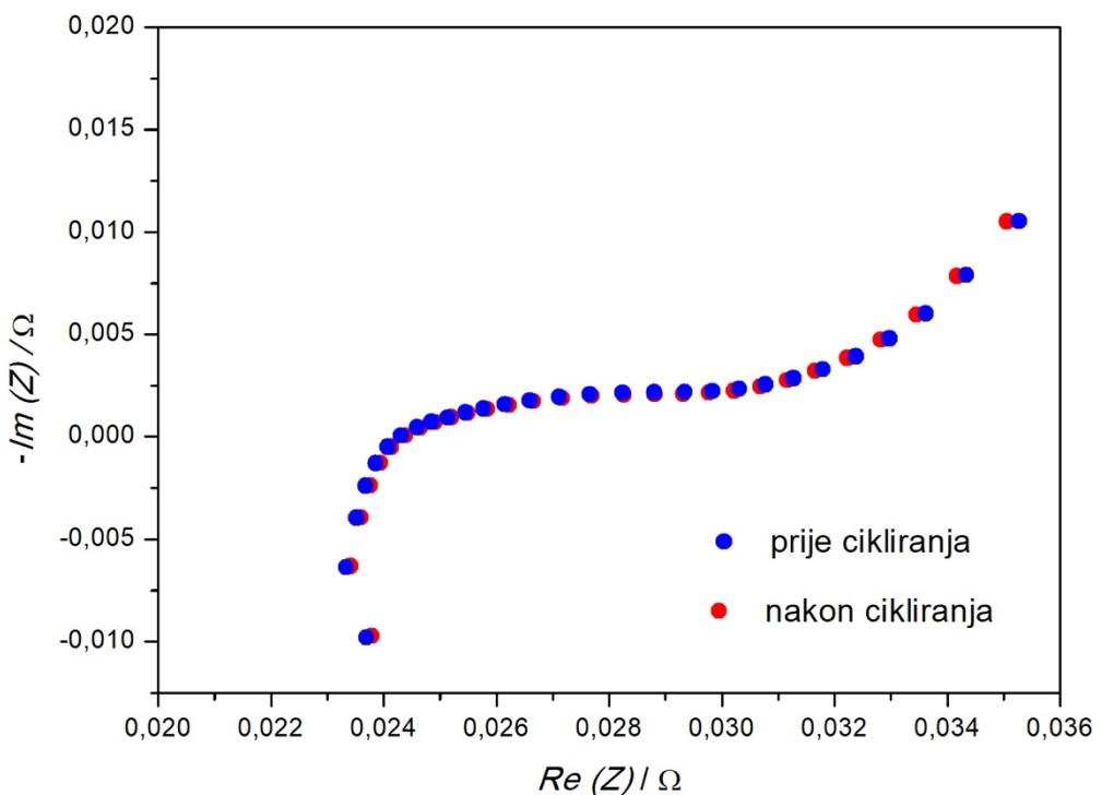
**Slika 4.5** Nyquistov prikaz ovisnosti imaginarne komponente o realnoj komponenti impedancije za napunjeni članak (4,2 V) prije i nakon cikliranja
