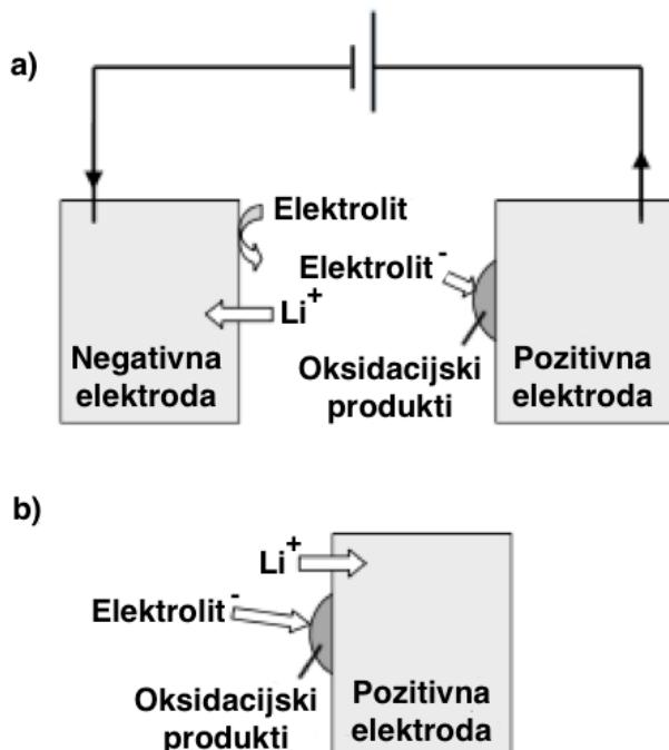
**Slika 2.4** prikaz mogućih reakcija oksidacije koje uklanjanju aktivni litij s elektrolita koji je umetnut u negativnu (a) ili pozitivnu (b) elektrodu. Ovdje je elektrolit molekula otapala u reduciranim oblicima ili anion soli [1]
