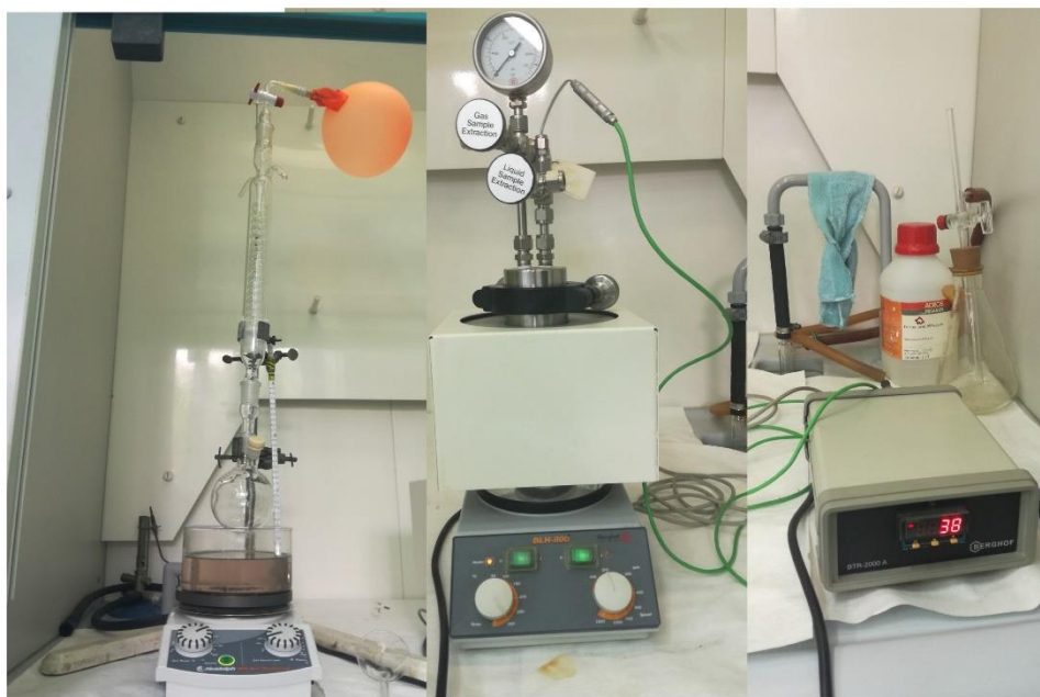
Slika 6. Aparatura za sintezu magnetitnih nanočestica: električno grijalo i miješalo, posuda s uljem, tikvica s okruglim dnom, Liebigovo hladilo na koje je spojen balon napunjen dušikom, autoklav i termostat
