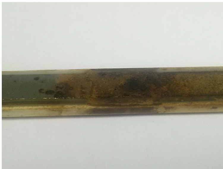
Slika 19. Dio katodno zaštićene čelične pločice koji se nalazio u naftnoj fazi.
