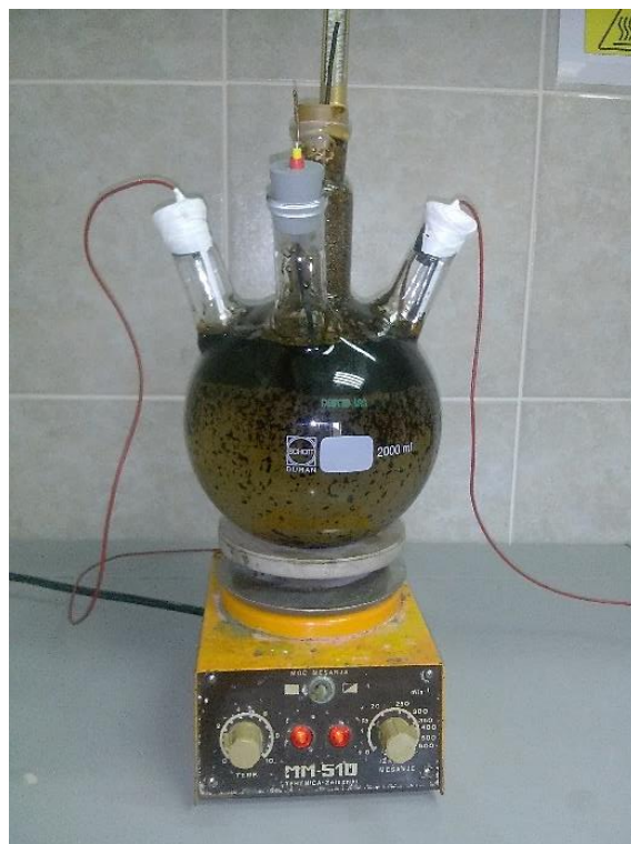
Slika 6. Aparatura neposredno nakon ulijevanja uzorka slojne vode postavljena na magnetsku miješalicu s grijačem.
