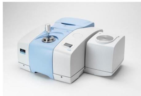
**Slika 3.3.1.** FTIR spektrometar Spectrum One (Perkin Elmer)
