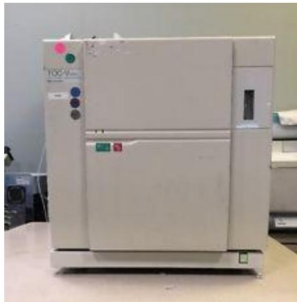
**Slika 3.4.2.** Instrument za analizu ukupnog organskog ugljika, Shimadzu TOC-V<sub>CPN</sub>
