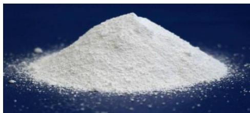
Slika 2.2.1. Titanijev dioksid ( $\text{TiO}_2$ ) [5]
