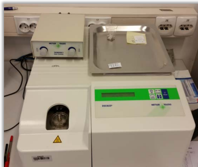
Slika 3.5. Fotografija diferencijalnog pretražnog kalorimetra Mettler Toledo 822 e (Mettler Toledo, Columbus, Sjedinjene Američke Države)
