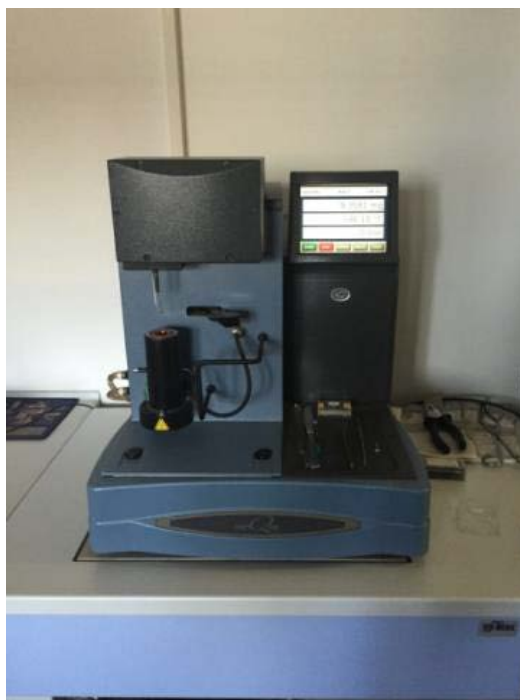
Slika 3.7. Fotografija uređaja za termogravimetrijsku analizu Q500 (TA Instruments, New Castle, SAD)
