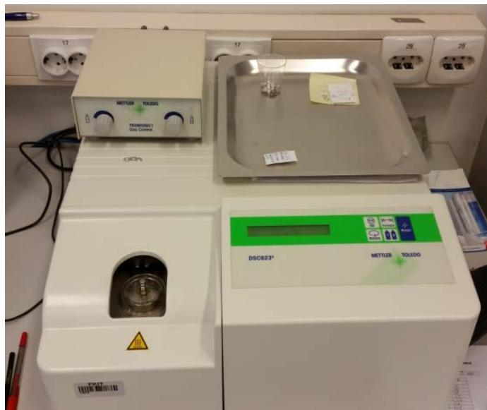
**Slika 10.** Fotografija diferencijalnog pretražnog kalorimetra Mettler Toledo 822<sup>e</sup>
