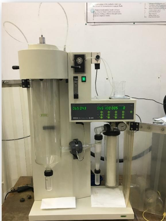
**Slika 9.** Fotografija sušionika s raspršivanjem Mini Spray Dryer B-290
