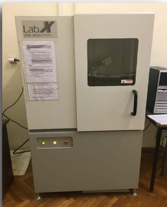
**Slika 12.** Fotografija uređaja za rendgensku difrakciju XRD 6000 (Shimadzu, Kyoto, Japan)
