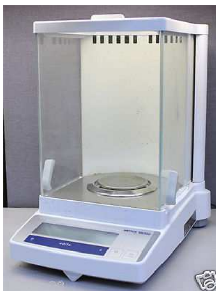
Slika 4. Analitička vaga Mettler Toledo, AB 104 [22]
