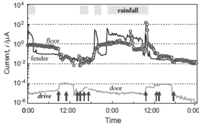
**Slika 20.** Prikaz izlazne struje ACM senzora prskan čistom vodom<sup>14</sup>
