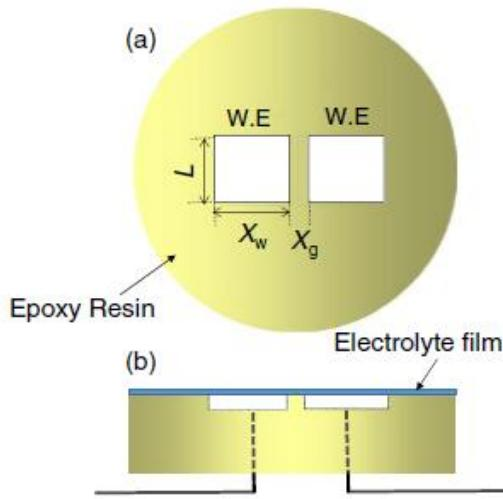
**Slika 14.** Shematski prikaz dvoelektrodne ćelije za EIS mjerjenje metala prekrivenog tankim elektrolitnim filmom: a) gornji i b) bočni pogled<sup>13</sup>
