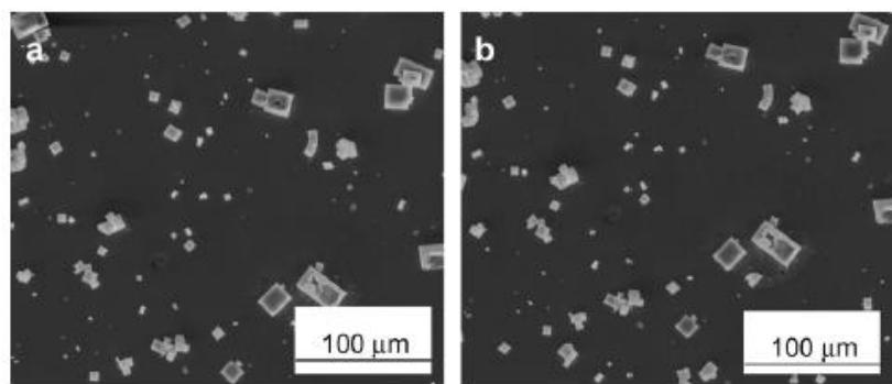
**Slika 7.** Morfologija uzorka čelika (Cor-ten A) na vremenske uvjete pri 60 % relativne vlažnosti: a) 0 h i b) 216 h<sup>12</sup>
