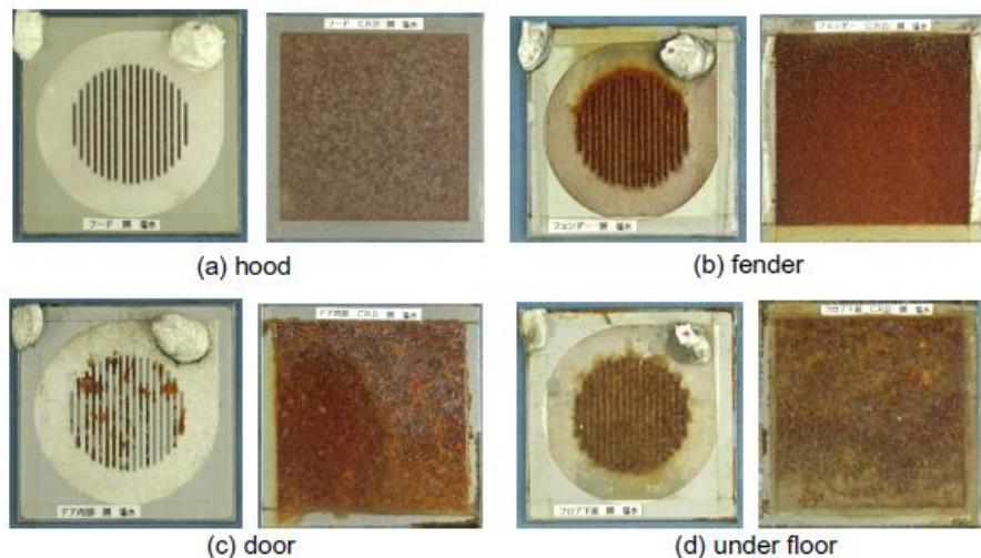
**Slika 21.** Prikaz ACM senzora izloženih prskanju slanom vodom<sup>14</sup>
