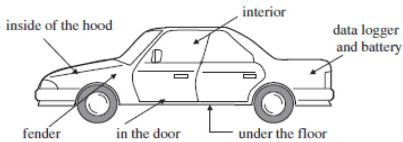
**Slika 17.** Položaji ACM senzora ugrađenih u automobil<sup>14</sup>
