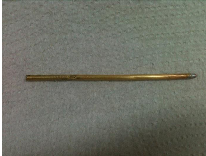
Slika 7. Bakreni nosač termopara
