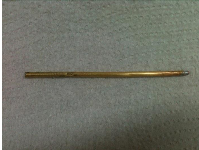
Slika 7. Bakreni nosač termopara
