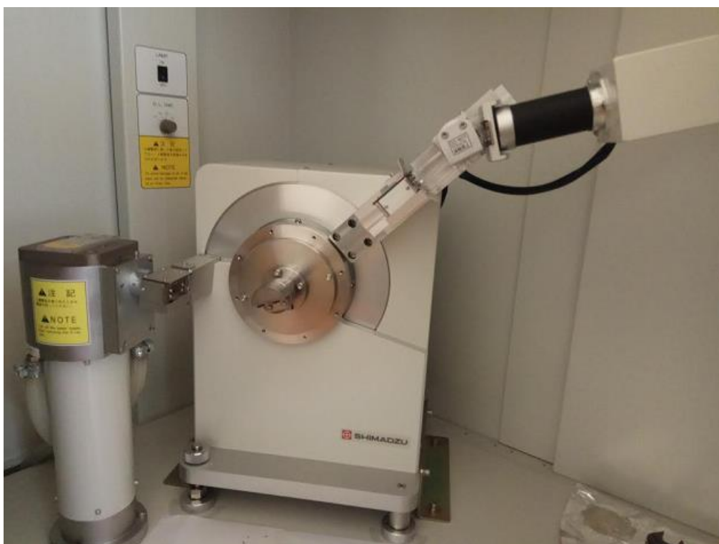
Slika 10: Korišteni uređaj za rendgensku difrakciju, XRD 6000 Shimadzu
