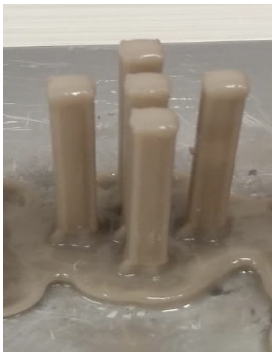
Slika 4.2. 3D-ispisani monoliti na radnoj podlozi 3D-pisača Form 2
