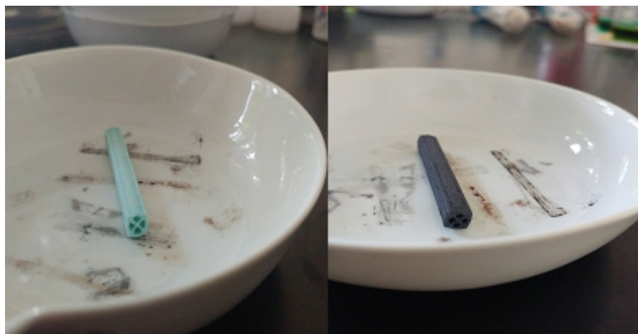
Slika 4.18. Usporedba impregniranog 3D-ispisanog nosača prije (lijevo) i nakon kalčiniranja (desno)
