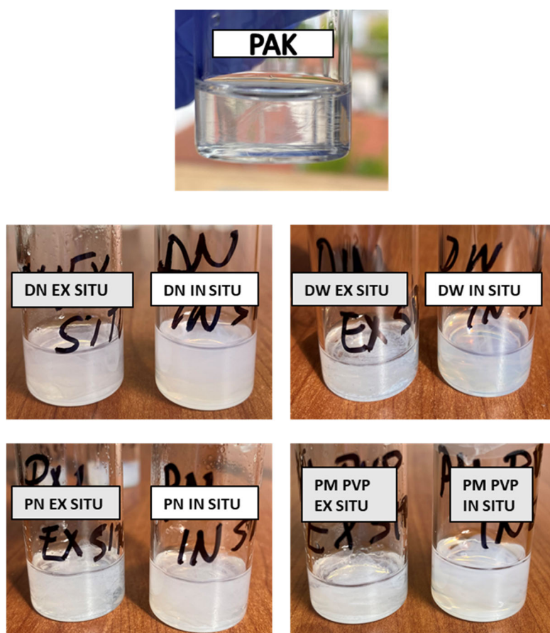
Slika 67. Prikaz neotopljenih premaza u THF-u.
