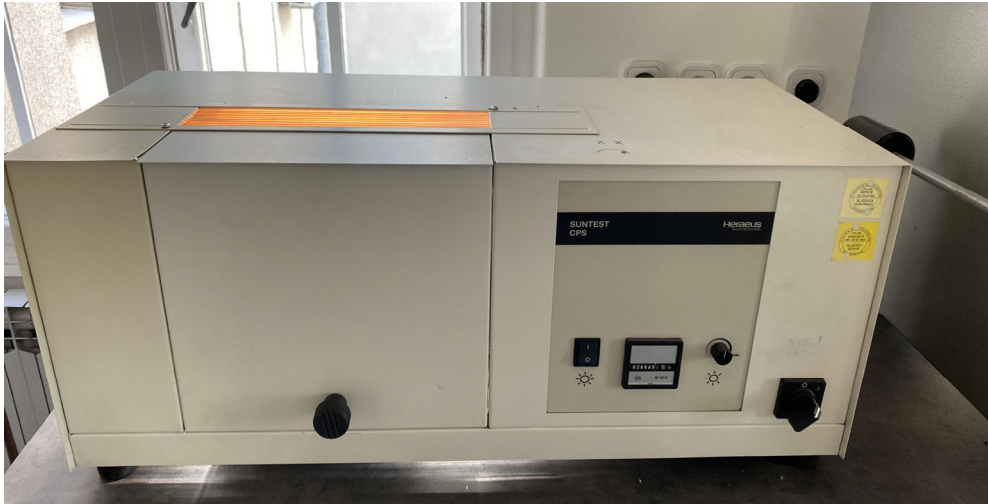
Slika 27. SUNTEST uređaj za UV-izlaganje premaza.
