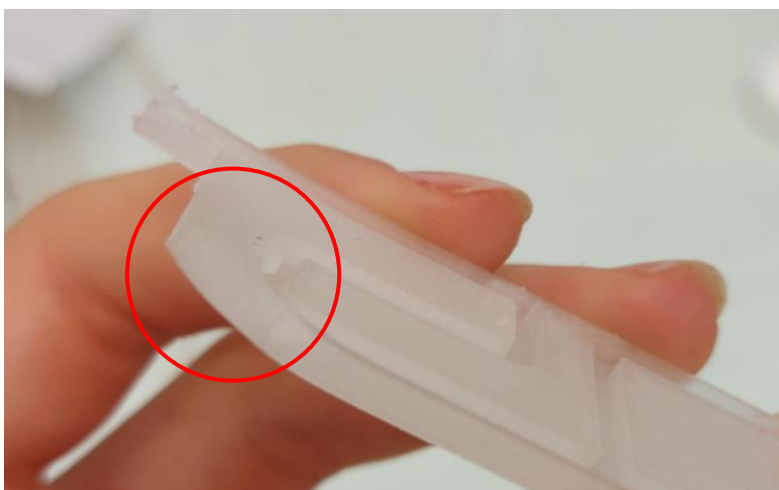
Slika 32. Pogreška u ispisu reaktora
