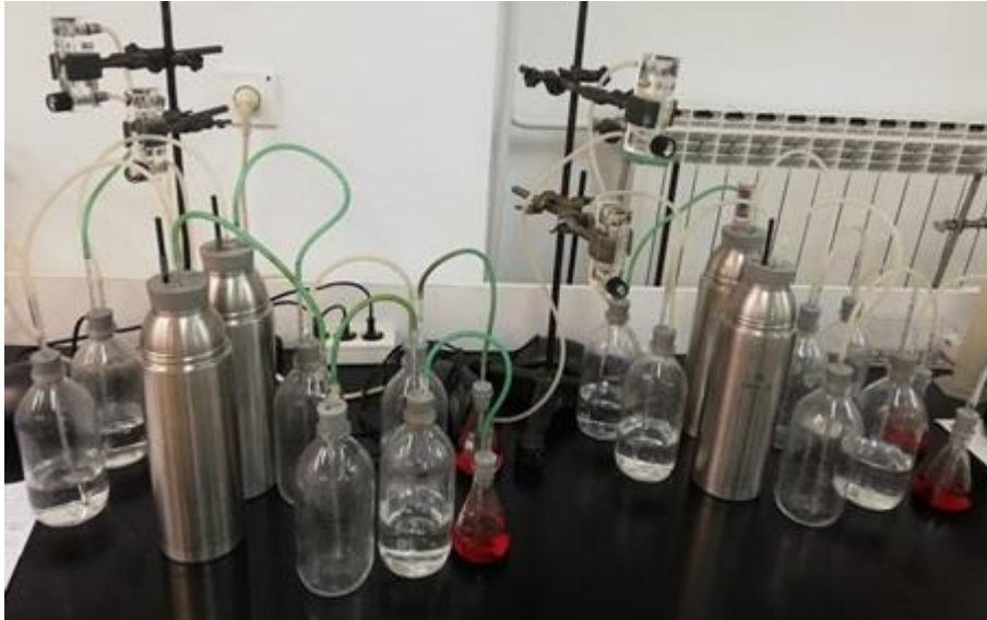
Slika 3.3. Adijabatski reaktor V_r = 1 L.
