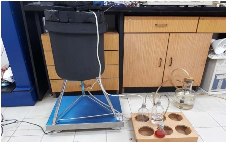
Slika 3.4. Adijabatski reaktor V_r = 10 L.
