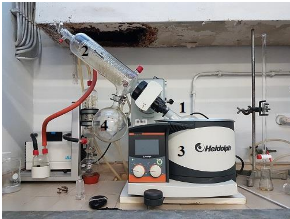
Slika 3.5. Aparatura za rotacijsku vakuum evaporaciju: (1) tikvica s uzorkom, (2) sustav za hlađenje, (3) vodena kupelj, (4) tikvica za sakupljanje kondenzata
