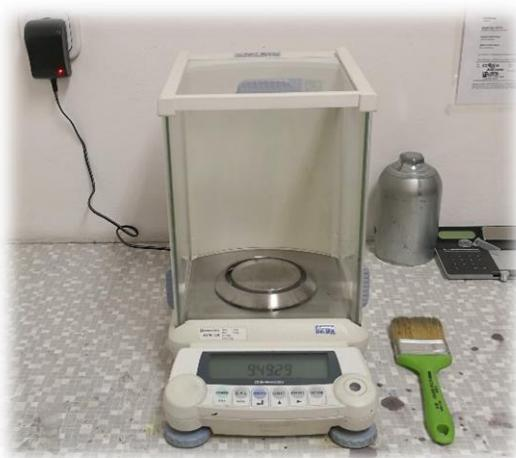
*Slika 3.4 Analitička vaga Shimadzu*
