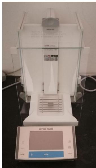
**Slika 15 - Analitička vaga Mettler Toledo XA105DU**
