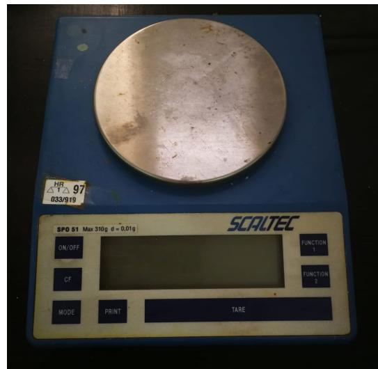
*Slika 14 - Digitalna tehnička vaga Scaltec SP0 51*
