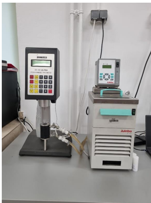
Slika 18. Rotacijski viskozimetar (Brookfield DV – III ULTRA) i termostat (Julabo F 12)
