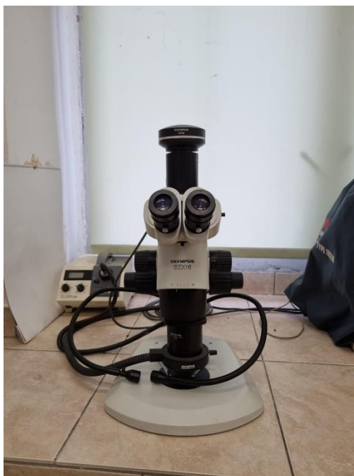
Slika 15. Mikroskop Olympus SZX16
