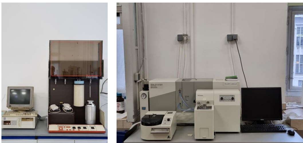
Slika 16. Uređaji za određivanje granulometrijskih karakteristika uzoraka papra: a) BET površina - Micromeritics ASAP 2000; b) raspodjela veličina čestica - Shimadzu SALD 3101
