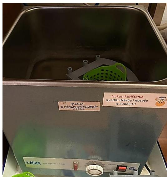
Slika 3.1. Korištena ultrazvučna kupelj
