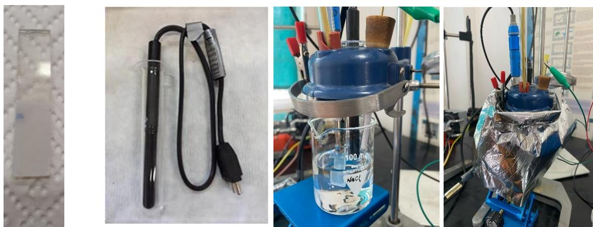
Slika 3.3. TiO<sub>2</sub> elektroda, UV lampa, elektrokemijska čelija i elektrokemijska čelija pod utjecajem UV svjetlosti, zaštićena zbog mogućih neželjenih učinaka
