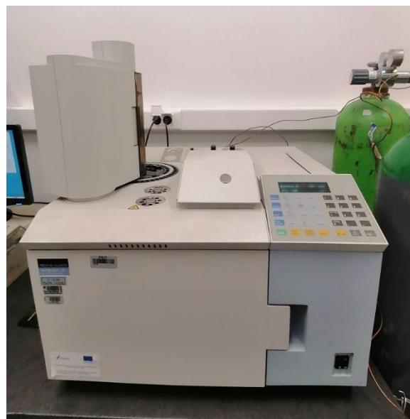
Slika 3.7. Plinski kromatograf opremljen TCD detektorom
