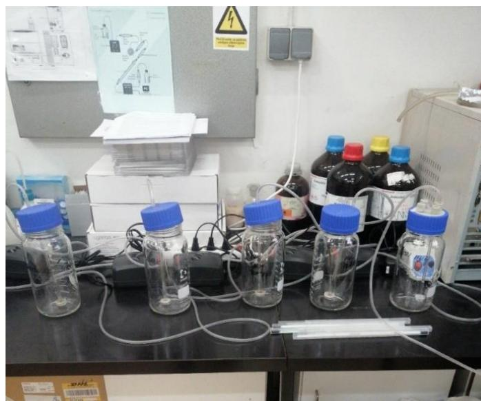
**Slika 15.** Reaktori za provedbu postupka biorazgradnje
