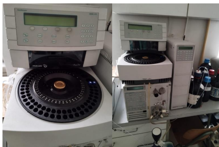
Slika 14. Tekućinski kromatograf visoke djelotvornosti Varian ProStar 500, Sjedinjene Američke Države
