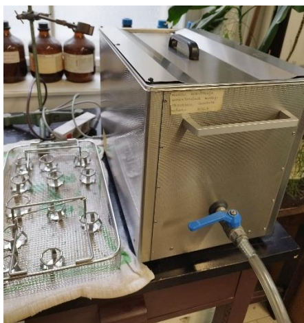
Slika 10. Ultrazvučna kupelj Sonorex digital 10 P, Bandelin, Berlin, Njemačka
