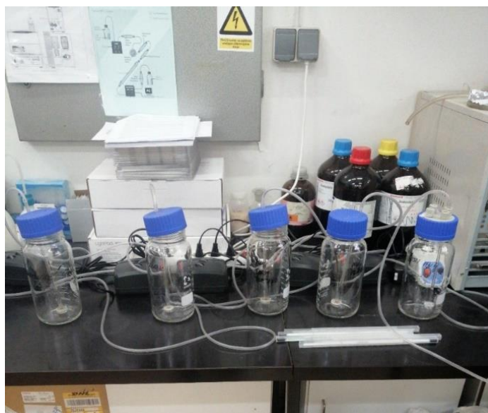
Slika 15. Reaktori za provedbu postupka biorazgradnje
