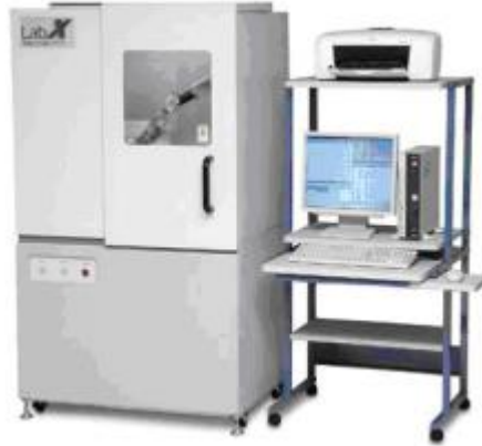
Slika 13. Fotografija uređaja za rendgensku difrakcijsku analizu praha XRD-6300 (Shimadzu, Kyoto, Japan)
