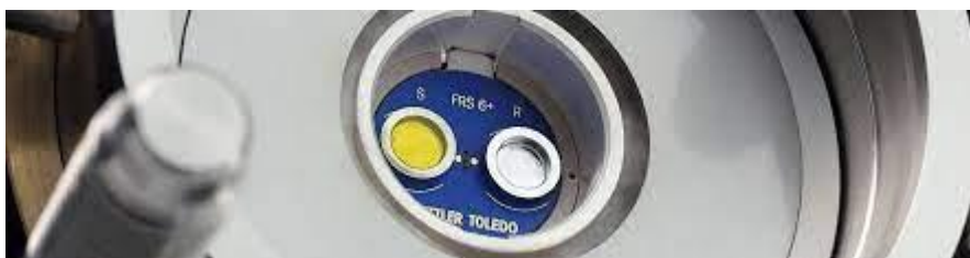
Slika 7. Prikaz mjesta za stavljanje referentnog materijala i uzorka
