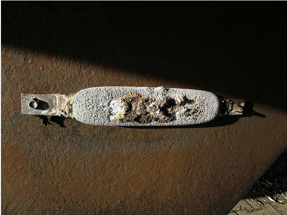
Slika 16. Primjer trošenja žrtvovane anode na trupu broda 28
