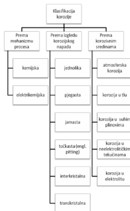
Slika 2. Klasifikacija korozijskih procesa <sup>2</sup>
