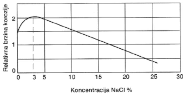
Slika 12. Utjecaj koncentracije NaCl-a na brzinu korozije čelika referenca<sup>5</sup>
