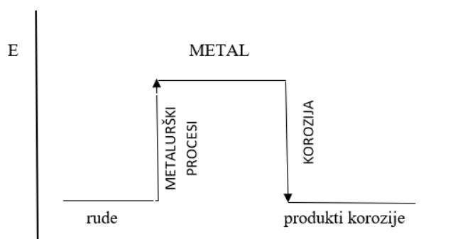
Slika 1. Energetske promjene pri dobivanju i koroziji metala<sup>6</sup>
