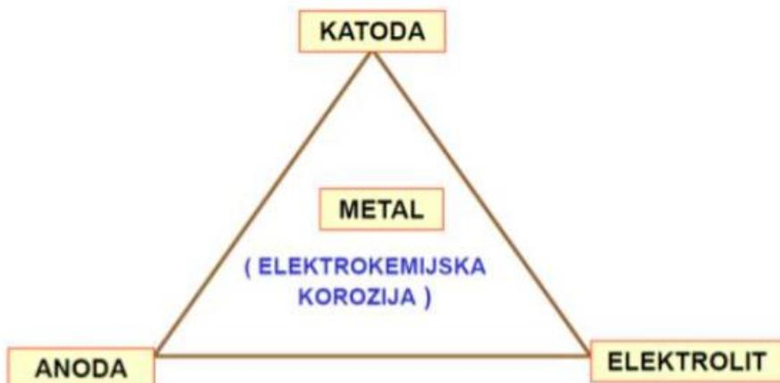
Slika 3. Osnovni elementi za odvijanje elektrokemijske korozije<sup>32</sup>
