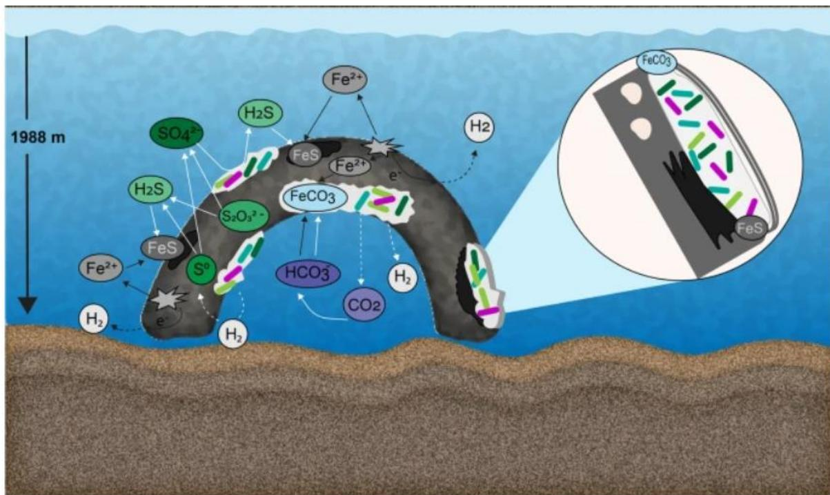
Slika 9. Shematski prikaz procesa koji izazivaju koroziju čelika u uvjetima dubokog mora<sup>11</sup>
