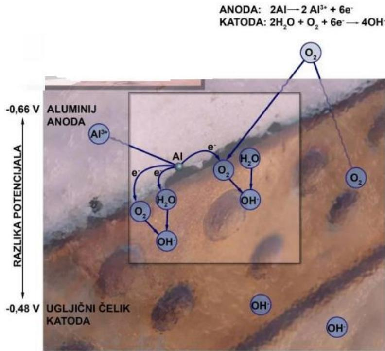
Slika 7. Prikaz galvanske korozije na brodu<sup>5</sup>
