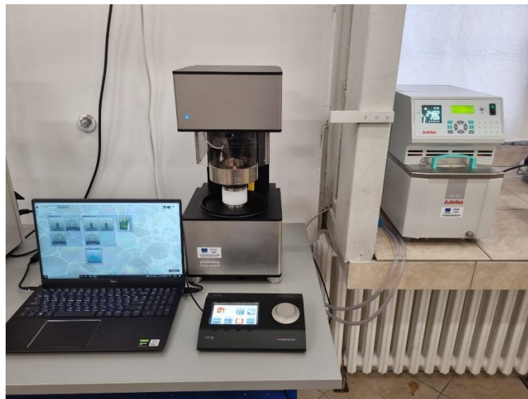
Slika 8. Tenziometar (Dataphysics, Njemačka) i termostat (Julabo, Njemačka)
