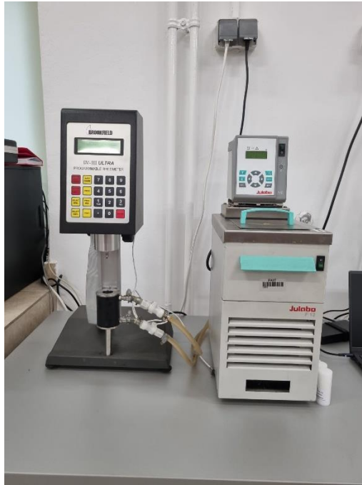
Slika 7. Reometar (Brookfield, Kanada) i termostat (Julabo, Njemačka)
