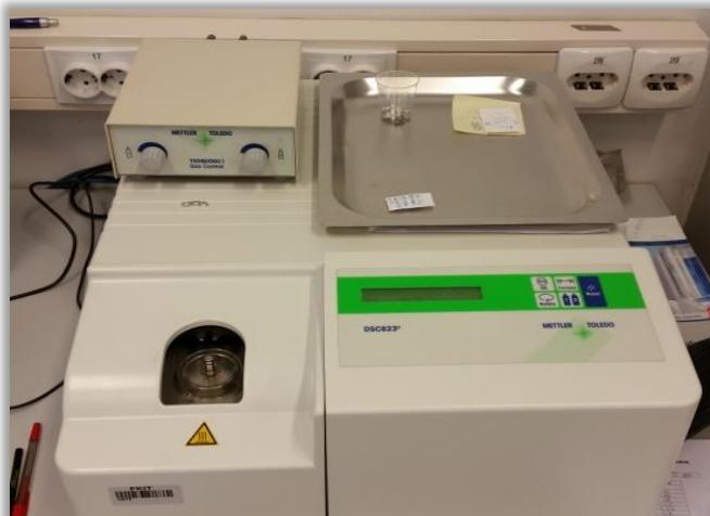
Slika 19. Fotografija diferencijalnog pretražnog kalorimetra Mettler Toledo 822<sup>e</sup> (Mettler Toledo GmbH, Griefensee, Švicarska)
