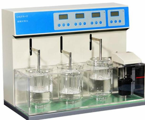
**Slika 26.** Fotografija uređaja za ispitivanje raspadljivosti tableta BJ 2
