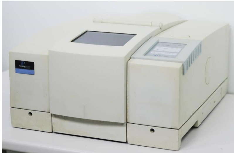
Slika 22. Fotografija FTIR spektrofotometra PerkinElmer Spectrum One (GmbH, Waltham, Massachusetts, SAD)
