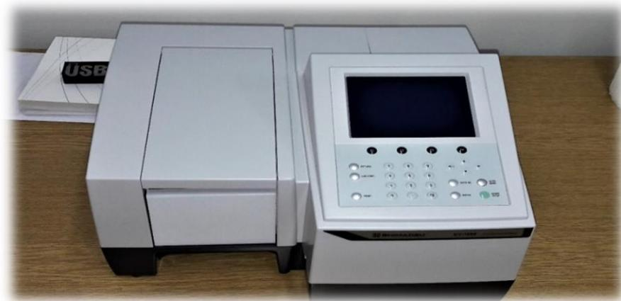
**Slika 27.** Fotografija spektrofotometra UV-1280 (Shimadzu, Kyoto, Japan)
