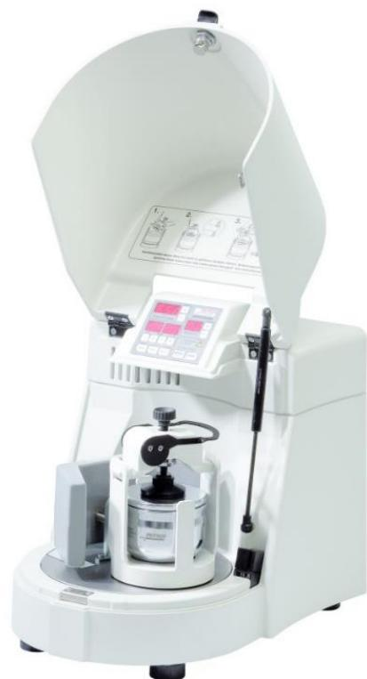
**Slika 13.** Planetarni kuglični mlin Pulversitte 6
