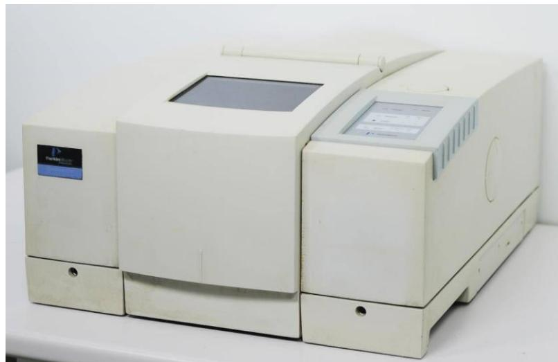
**Slika 22.** Fotografija FTIR spektrofotometra
