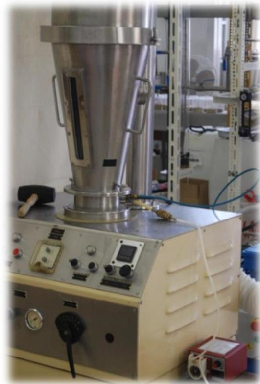
**Slika 2.** Fotografija granulatora s fluidiziranim slojem Uni-Glatt
