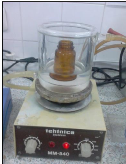
Slika 3.2. Kotlasti reaktor u termostatiranoj kupelji na magnetskoj miješalici
