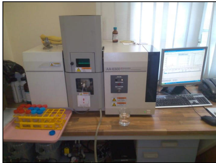
Slika 3.5. Atomski apsorpcijski spektrometar Shimadzu AA – 6300
