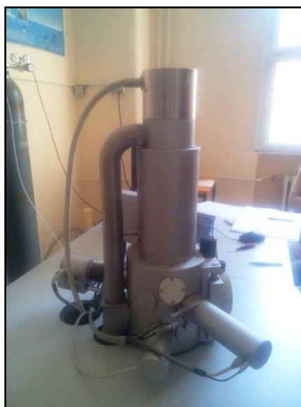
Slika 3.7. Pretražni elektronski mikroskop SEM Tescan Vega III Easyprobe
