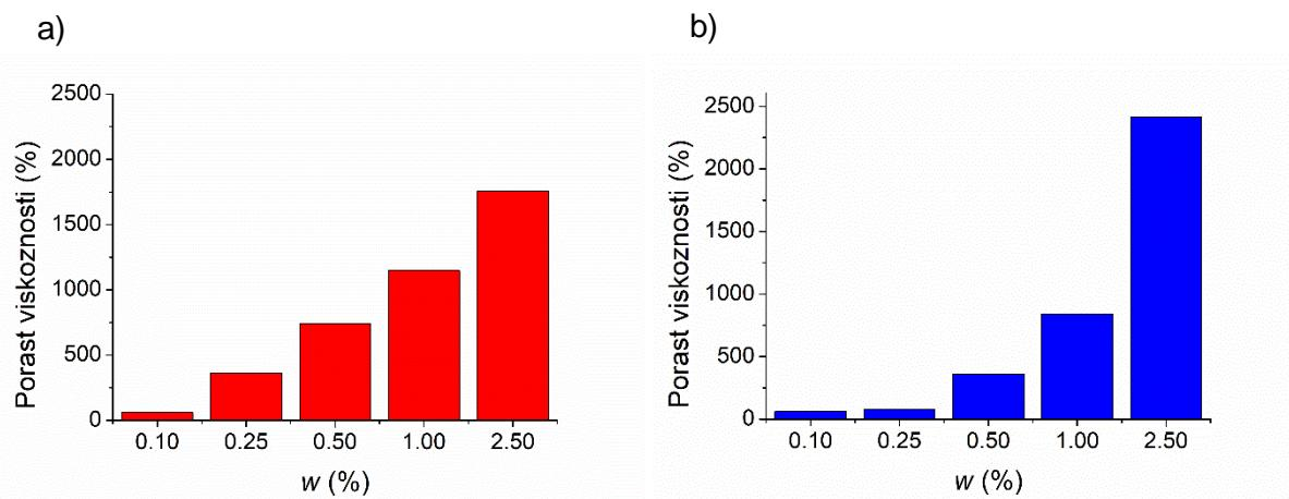
**Slika 4.12.** Porast viskoznosti pri smičnoj brzini od  $1000 \text{ s}^{-1}$  za a) FAiBE i b) repičino ulje
