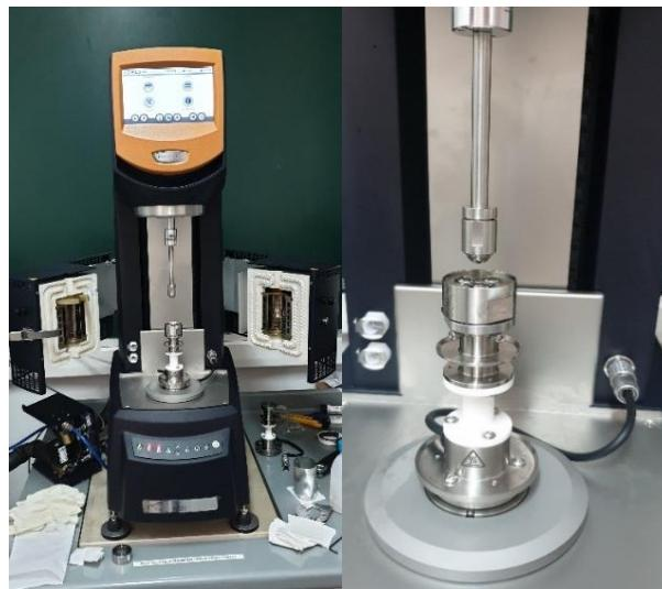
**Slika 3.19.** Prikaz aparature za ispitivanje mazivosti
