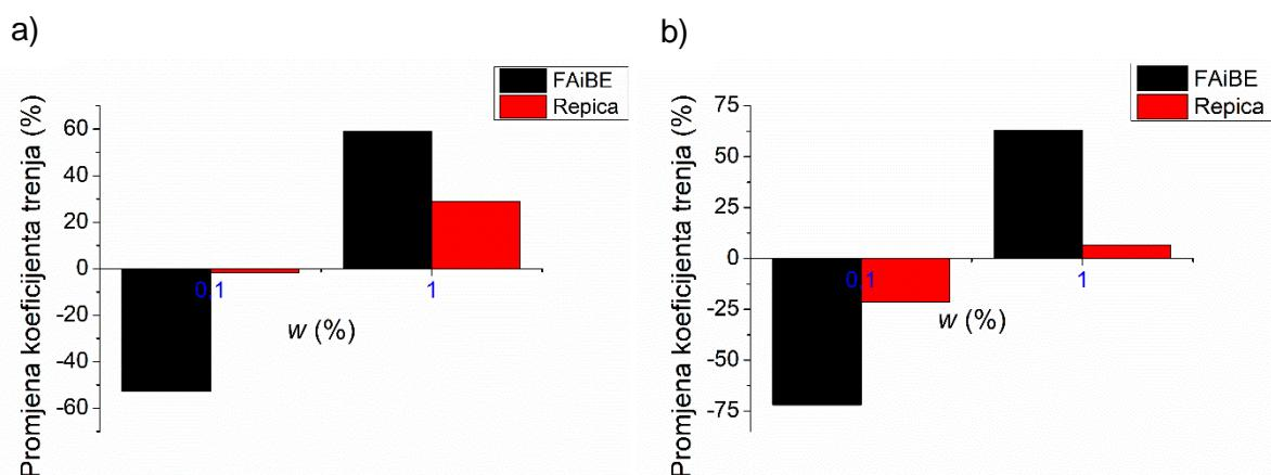
**Slika 4.15.** Postotna promjena koeficijenta trenja za nanofluid na osnovi biodizela i repičinog ulja za brzine klizanja a)  $100\ 000\ \mu\text{m s}^{-1}$  i b)  $150\ 000\ \mu\text{m s}^{-1}$
