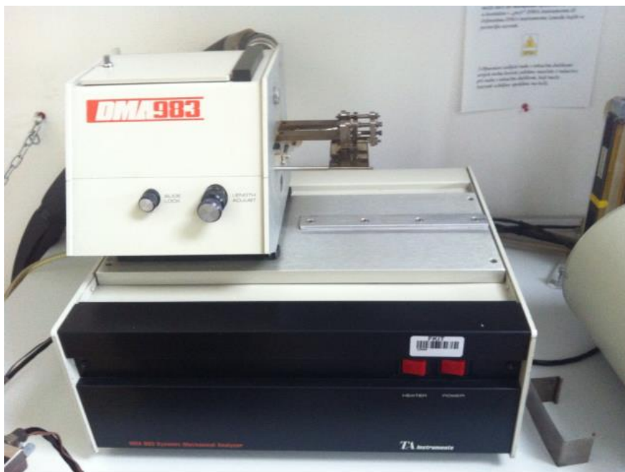
Slika 16. DMA analizator, Fakultet kemijskog inženjerstva i tehnologije.
