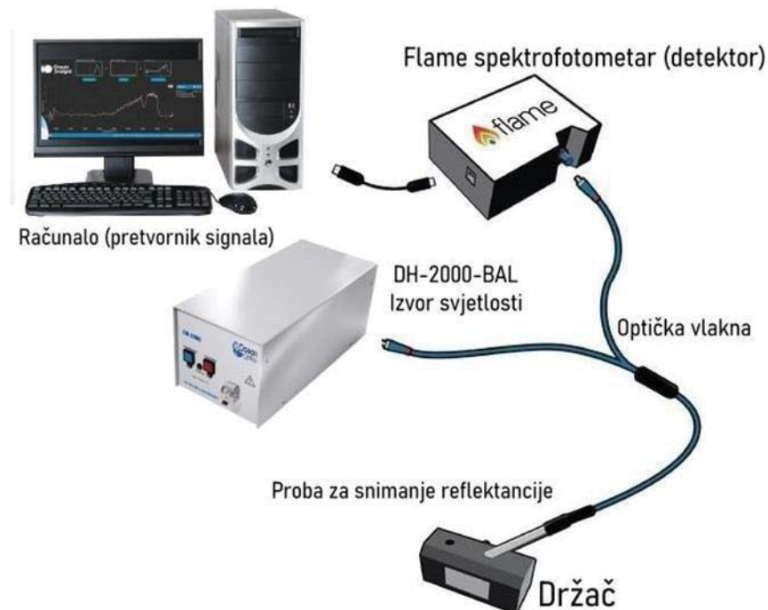
Slika 14. Prikaz instrumenta Ocean Optics Flame za mjerenje reflektancije
