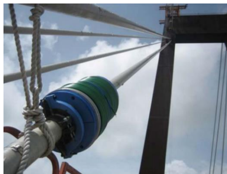
Slika 25. Primjena metode curenja magnetskog polja na kabel čeličnog mosta [28]
